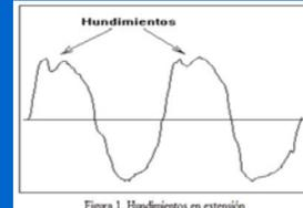
Figura 1. Hundimientos en extensión
